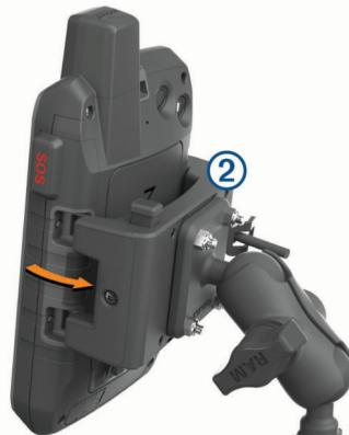
**3** Inclinez l'appareil vers le côté opposé jusqu'à ce qu'il se mette en place, afin d'éviter qu'il ne tombe.
