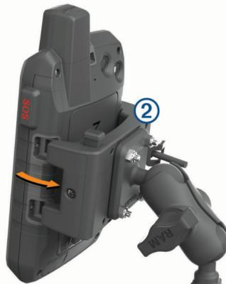
3 Inclina el dispositivo hacia el lado contrario hasta que encaje en su sitio y así evitar que este se caiga.
