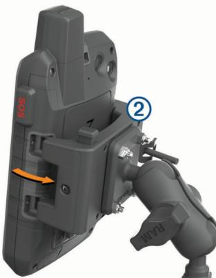
3 Przechyl urządzenie w przeciwną stronę, aż zatrzaśnie się na swoim miejscu, aby zapobiec jego wypadnięciu.
